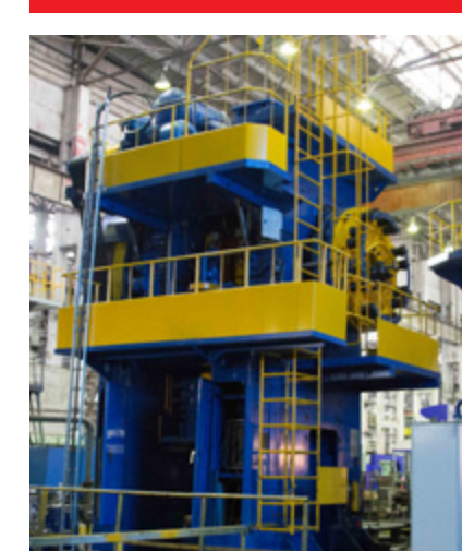
Горячештампочный пресс КБ 8544 усилием 2 500 тс и пресс К 9536 усилием 400 тс KB 8544 hot-forging press (2,500 tf) and K 9536 press (400 tf)
