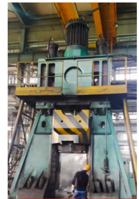
Гидравлический штамповочный молот мпч 16 т Hydraulic closed-die forging hammer (falling weight 16 t)
