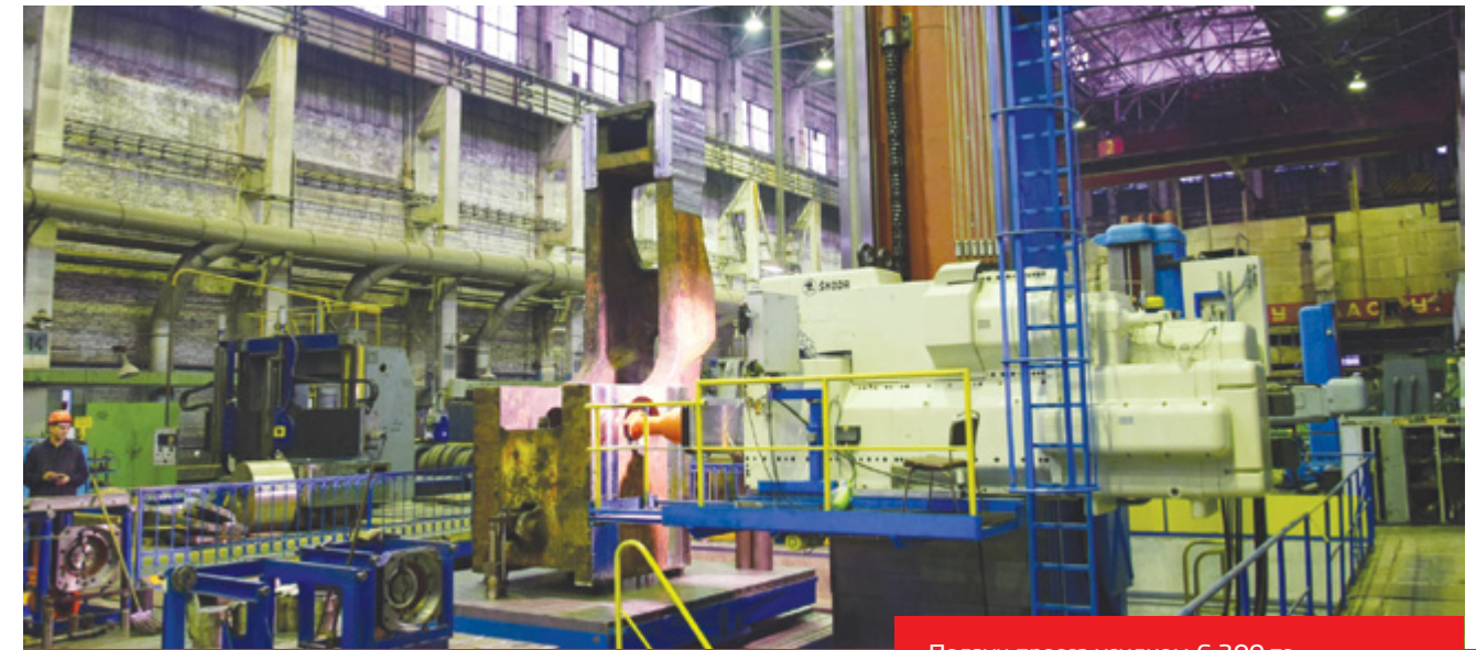
Ползун пресса усилием 6 300 тс Ram for 6,300 tf press
