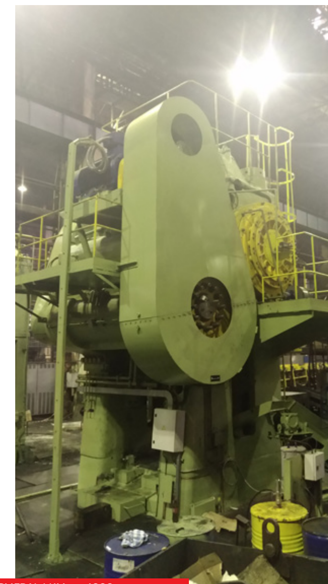
Ковочно-штамповочный пресс SMERAL LKM ус. 4000 тс Hot forging press SMERAL LKM (4,000 tf)
