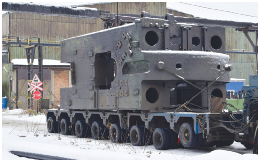
Перемещение шаботов молотов мпч 5 и 10 т Transportation of 5 and 10 t hammers anvil blocks
