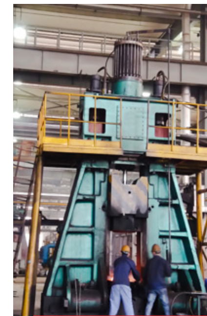
Гидравлический штамповочный молот мпч 5 т Hydraulic closed-die forging hammer (falling weight 5 t)
