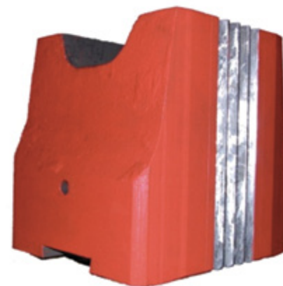
Баба штамповочного молота мпч 10 т 10 ton hammer ram
