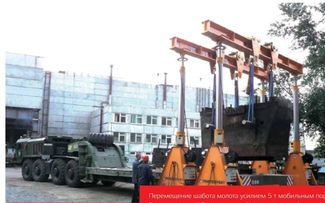
Перемещение шаботов молотов мпч 5 и 10 т Transportation of 5 and 10 t hammers anvil blocks
