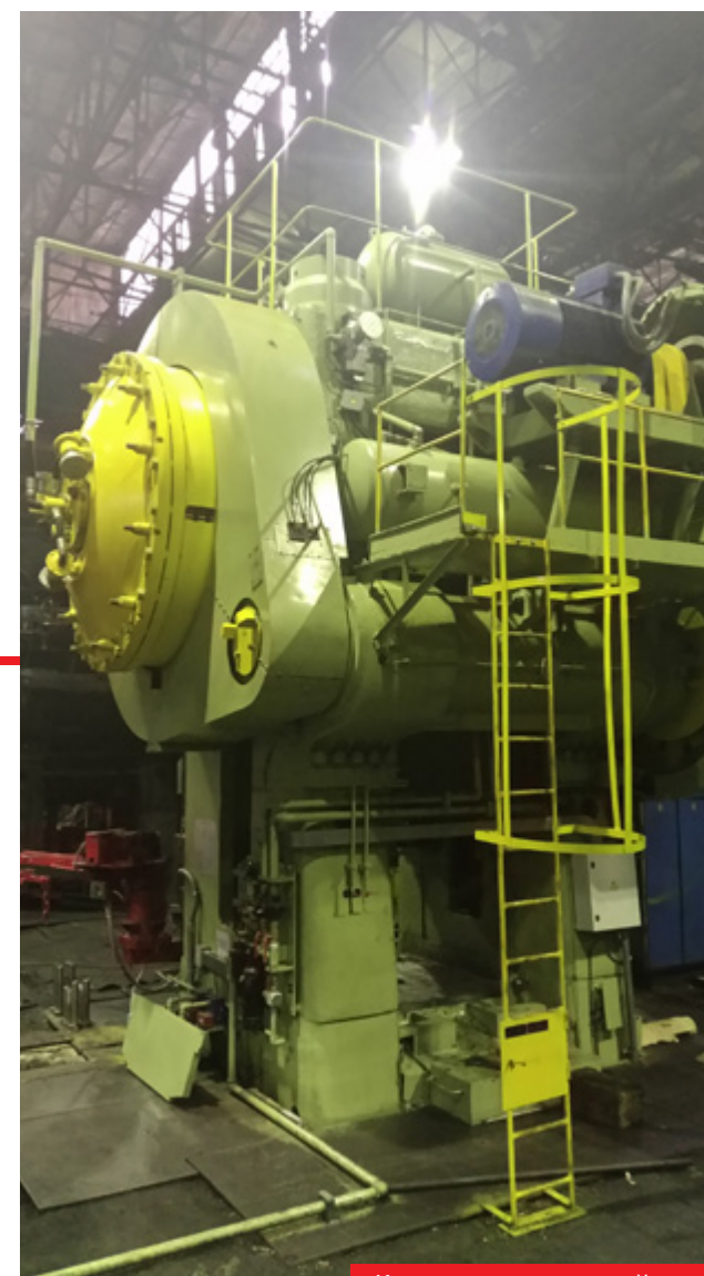
Ковочно-штамповочный пресс SMERAL LKM ус. 4000 тс Hot forging press SMERAL LKM (4,000 tf)
