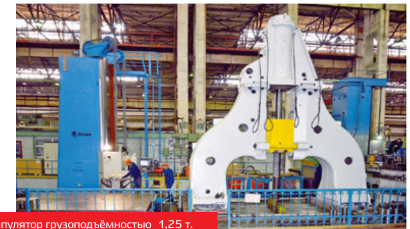
Ковочный молот мпч 3,15 т и рельсовый манипулятор грузоподъемностью 1,25 т. Forging hammer (falling weight 3.15 t) and 1.25 t rail-bound manipulator.
