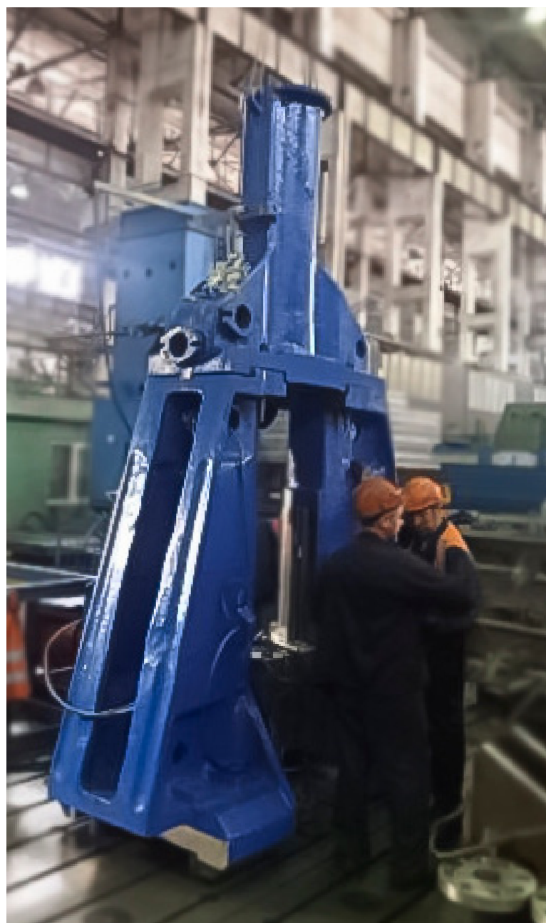
Молот М 2140 мпч 1 т M 2140 hammer (falling weight 1 t)
