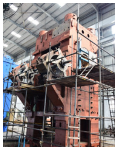
Модернизация пресса усилием 6 300 тс Modernization of 6,300 tf press
