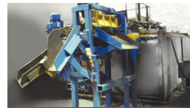
Станция по разбраковке заготовок перед штамповкой Sorting unit
