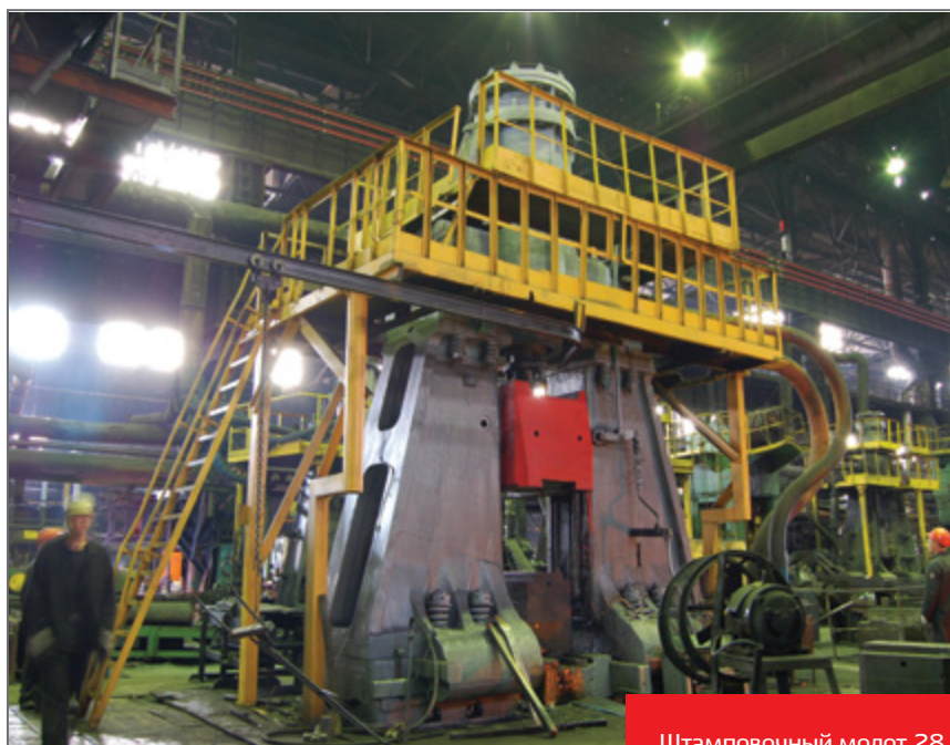
Штамповочный молот 28 кп мпч 10 т после ремонта Forging hammer 28kp (falling weight 10 t) after repair
