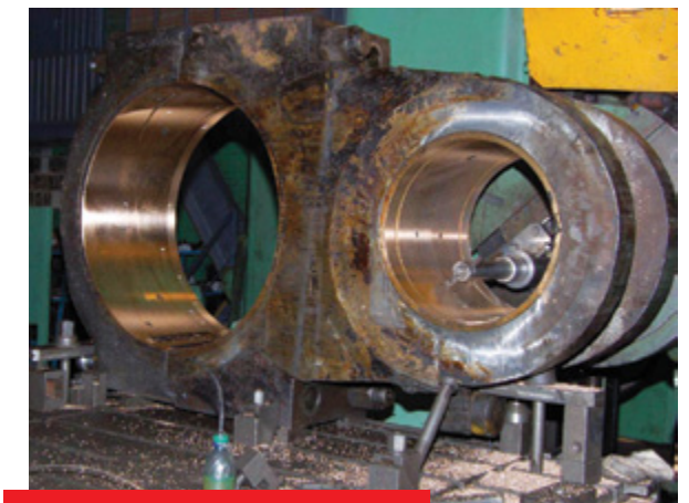
Шатун КГШП-2 500 Pitman for 2,500 tf forging press
