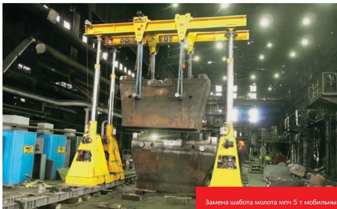
Перемещение шаботов молотов мпч 5 и 10 т Transportation of 5 and 10 t hammers anvil blocks
