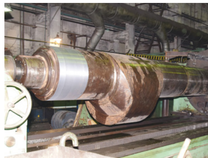
Вал эксцентриковый пресса усилием 6 300 тс Excentrical shaft for 6,300 tf press
