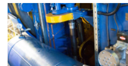
Горячештампочный пресс КБ 8544 усилием 2 500 тс и пресс К 9536 усилием 400 тс KB 8544 hot-forging press (2,500 tf) and K 9536 press (400 tf)
