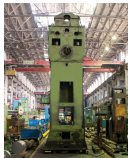
Листоштамповочный пресс Erfurt PKZ 630 Sheet stamping press Erfurt PKZ 630
