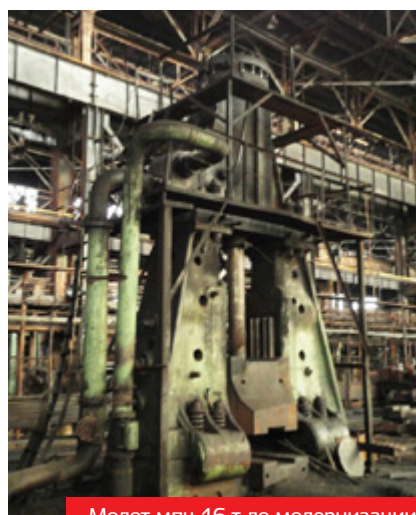
Молот мпч 16 т до модернизации Hammer (falling weight 16 t)
