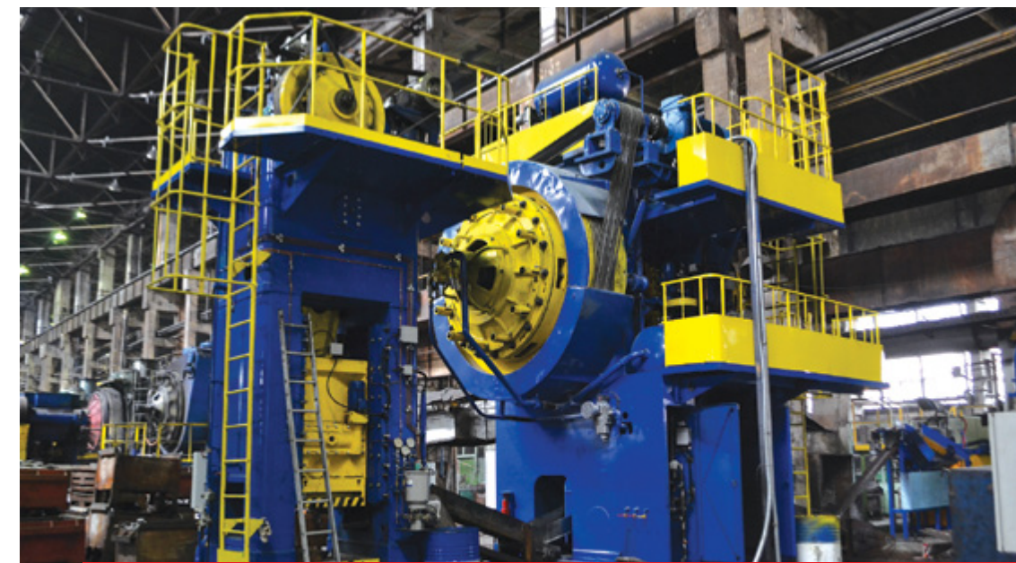
Ковочный молот мпч 3,15 т и рельсовый манипулятор грузоподъемностью 1,25 т. Forging hammer (falling weight 3.15 t) and 1.25 t rail-bound manipulator.
