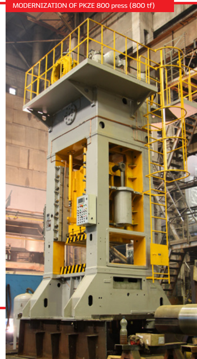
Модернизация пресса РКЗЕ 800 ус. 800 тс MODERNIZATION OF PKZE 800 press (800 tf)
