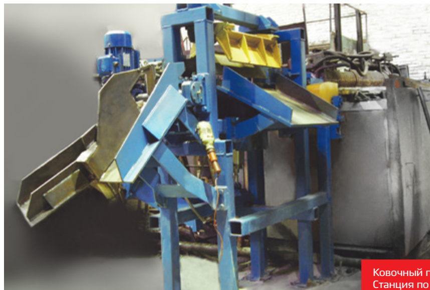
Ковочный пресс ЛКМ-4000 Разводка смазки по шатуну в сборе Forging press LKM-4000 Lubrication piping for piston rod assembly unit
