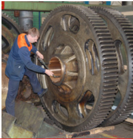
Проверка деталей пресса индикатором Skoda W200 Press parts checking by Skoda W200 indicator
