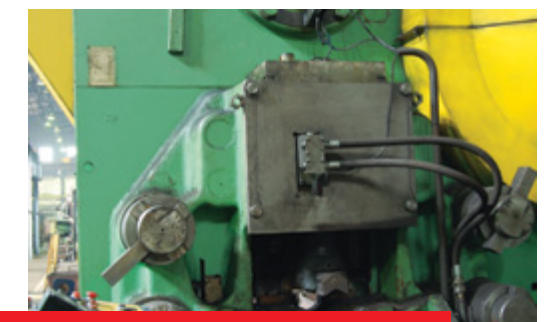
Спроектирован и изготовлен гидropriжим Designed and manufactured hydraulic clamp
